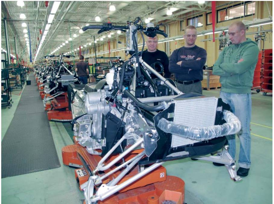
Kelkkaaihiot mutkittelevat ympäri kokoonpanohallia. Eri tiimit asentavat kelkkoihin osia omalla alueella, ja reitin lopussa kelkka on sitten täysin valmis. Rajamiehiä ihailemassa tehtaan toimintaa!
