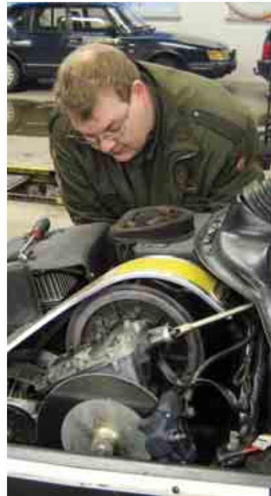
Kuljettaja vanhempi rajavartija Kimmo Karttimo vaihtaa moottorikelkkaan sytytysyksikköä.
