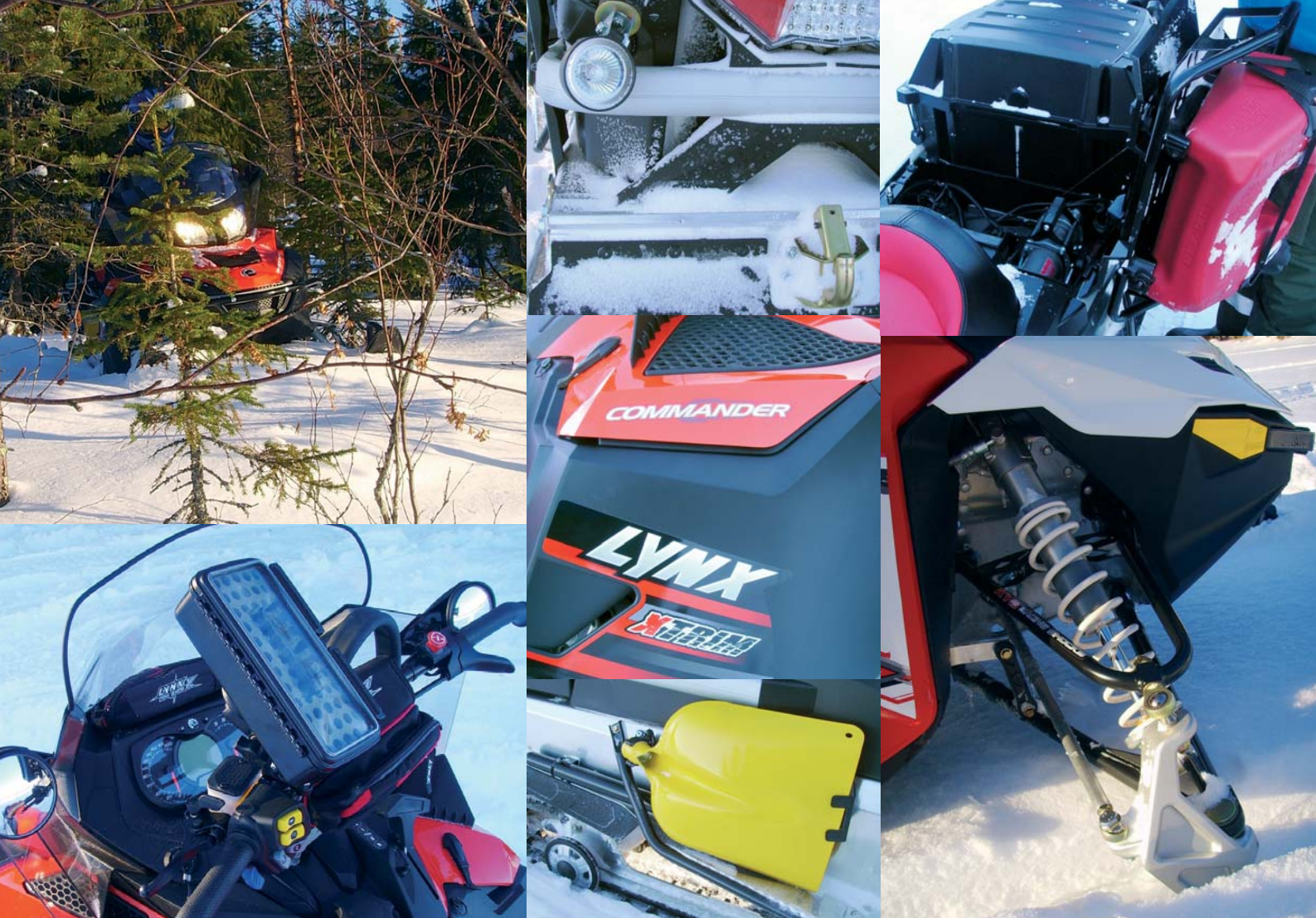
Oikealla alhaalla RAVEN etujousitusta. Sivun muut kuvat COMMANDERista, joka oli testin paras kelkka umpisella. COMMANDERin lisävarusteita: peruutusvalo, vinssi, bensakanisteri, säilytyslaukkuja, lämmitettävä GPS-kotelo sekä lapio - olisivat tarpeen myös RVL:n kelkkoihin.
